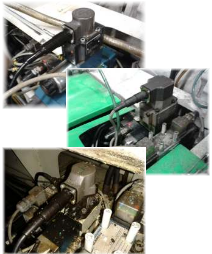
3 verschillende servokleppen van het fabrikaat Rexroth: Vuistgroot maar goud waard.
